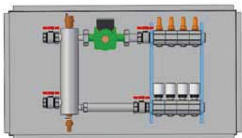
Il ClimaKit C-BT è studiato per le applicazioni a pannelli radianti in solo riscaldamento, dove non è richiesta alcuna valvola miscelatrice, poiché la produzione dell'acqua calda avviene già a bassa temperatura; gli attuatori elettrotermici sono dotati di microinterruttore di fine corsa per l'attivazione del circolatore dell'impianto.
